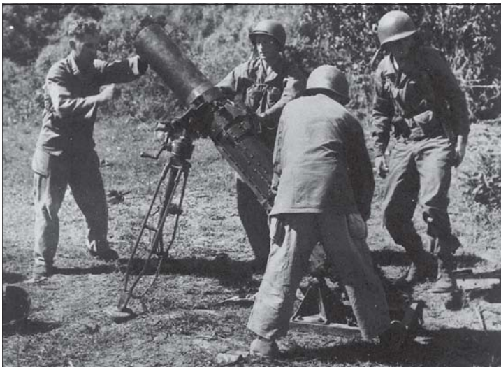
Японская пусковая установка для 8-дюймовых реактивных снарядов.
