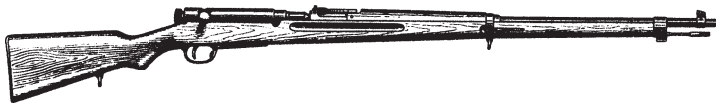
6,5-мм винтовка Арисака Тип 38. Длина без штыка 1270 мм; вес без штыка 3,9 кг, прицельная дальность 1500 м.
