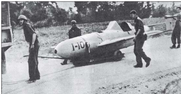
Оружие «камикадзе» — человекоуправляемый самолет-снаряд «Ока», захваченный американцами на Окинаве.
