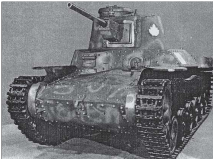
Средний танк «Чи-Хе» (Тип 1) был дальнейшим развитием танка «Чи-Ха». Боевая масса — 17,2 т; вооружение — 47-мм пушка и два 7,7-мм пулемета; бронирование — 20—50 мм; экипаж — 5 чел.; скорость по шоссе — 44 км/ч; запас хода — 210 км. До конца войны была построена 601 машина этого типа.
